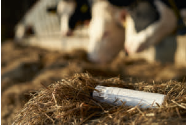
Pansenboli der Fa. smaXtec – die Firma ist ebenfalls Forschungspartner im Projekt D4Dairy – dienen dazu, wertvolle Informationen wie PH-Wert, Temperatur über die Vorgänge direkt im Pansen zu erfassen. © smaXtec
